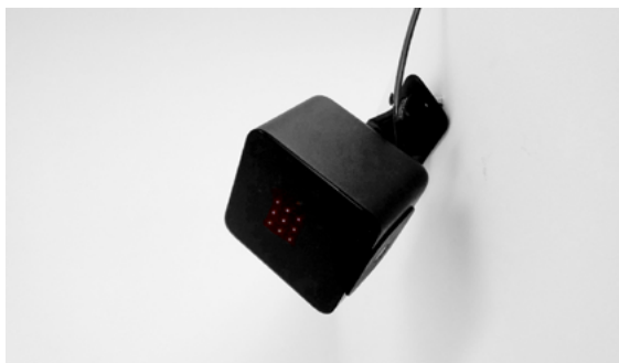
Rysunek 132. Stacja bazowa HTC Vive na ścianie boksu
